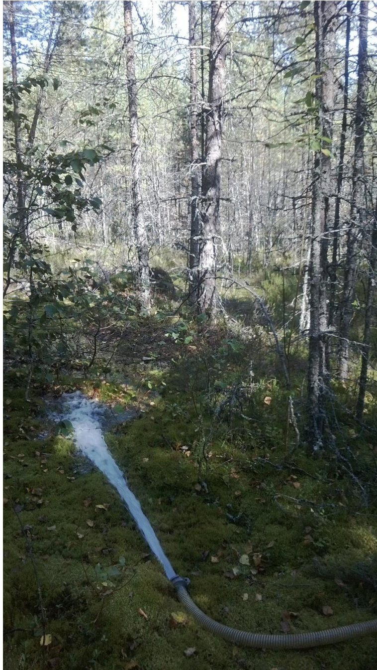
Kuva 4. Ominaisantoisuuspumppaus Hoseuskankaalla Parkanossa. Kuva: Nina Nenonen 27.8.2013
