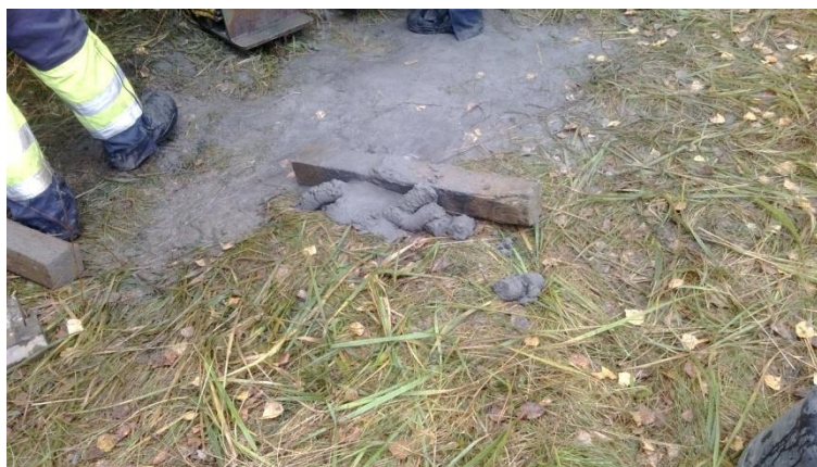
Kuva 38. Siivilän tukkinutta hienoainesta tutkimuspisteellä 890. Kuva: Nina Nenonen 30.9.2013.
