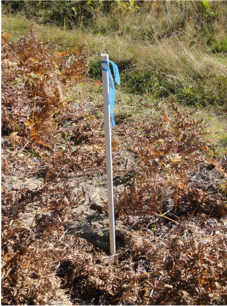
Kuva 3. Väliaikainen pohjaveden havaintoputki, Sastamala. Kuva: Satu Appelqvist 5.9.2013
