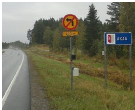
Kuva 23. Tutkimusta varten kehitetty videokuvausjärjestelmä liikennemerkkiin asennettuna. Videokamera on mustassa laatikossa ja virransyöttö akuista vaaleassa kotelossa.
