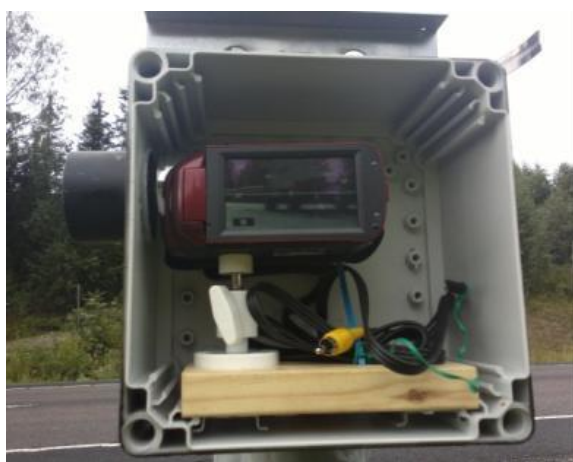
Kuva 23. Tutkimusta varten kehitetty videokuvausjärjestelmä liikennemerkkiin asennettuna. Videokamera on mustassa laatikossa ja virransyöttö akuista vaaleassa kotelossa.
