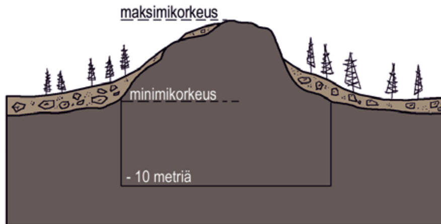
Kuva 9. Kallioalueen poikkileikkaus. Kiviaineksen määräarvioon lasketaan se kiviaines määrä, joka on tasojen "maksimikorkeus" ja "minimikorkeus" välillä. Tässä hankkeessa maanpinnan alapuolisia kiviainesvaroja ei ole arvioitu.
