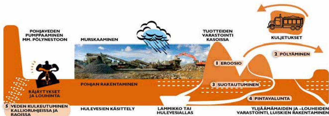
Kuva 14. Arseenin leviämismekanismit kiviainestuotannossa (Lehtinen ym. 2014).
