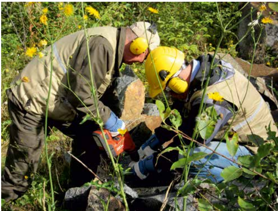
Kuva 15. Näytteenotto poravasaralla, kuvassa geologit Heikki Nurmi ja Jouko Vuokko Geologian tutkimuskeskuksesta. Koivisto, Pirkkala, 20.8.2014 © Samrit Luoma
